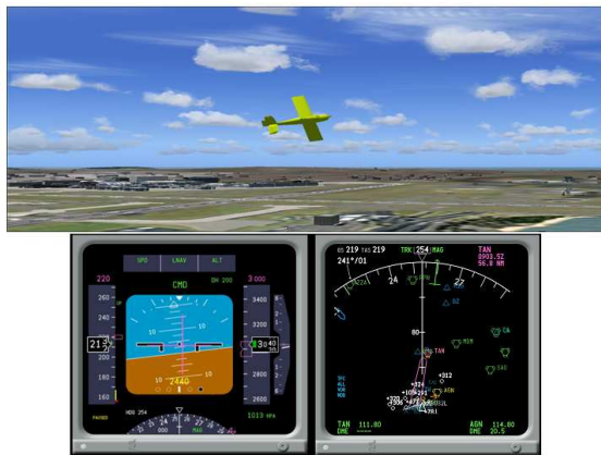
Rys. 6. Model samolotu i środowiska ruchu symulatora oraz formy graficzne parametrów pilotażowych i nawigacyjnych prezentowanych na wskaźnikach PFD i ND
