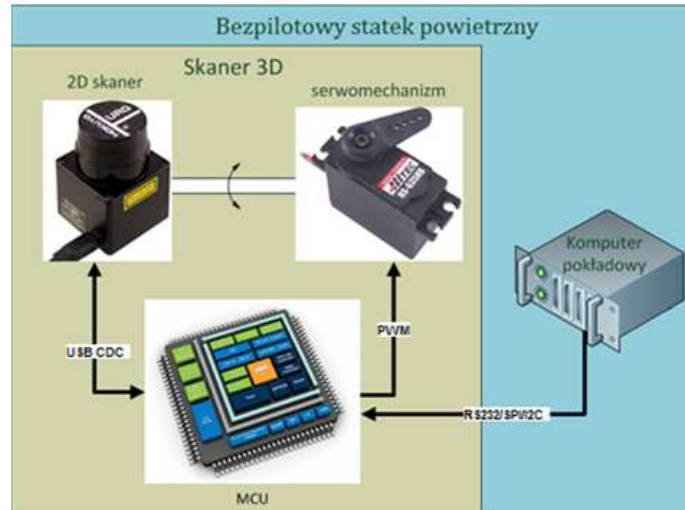
Rys. 3. Schemat funkcjonalny skanera 3D
