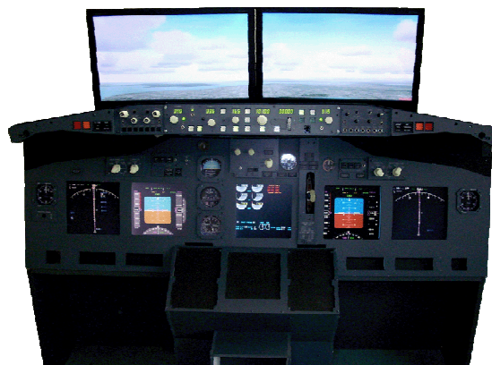
Rys. 2. Stanowisko symulatora kabiny samolotu pasażerskiego Boeing 737 NG
