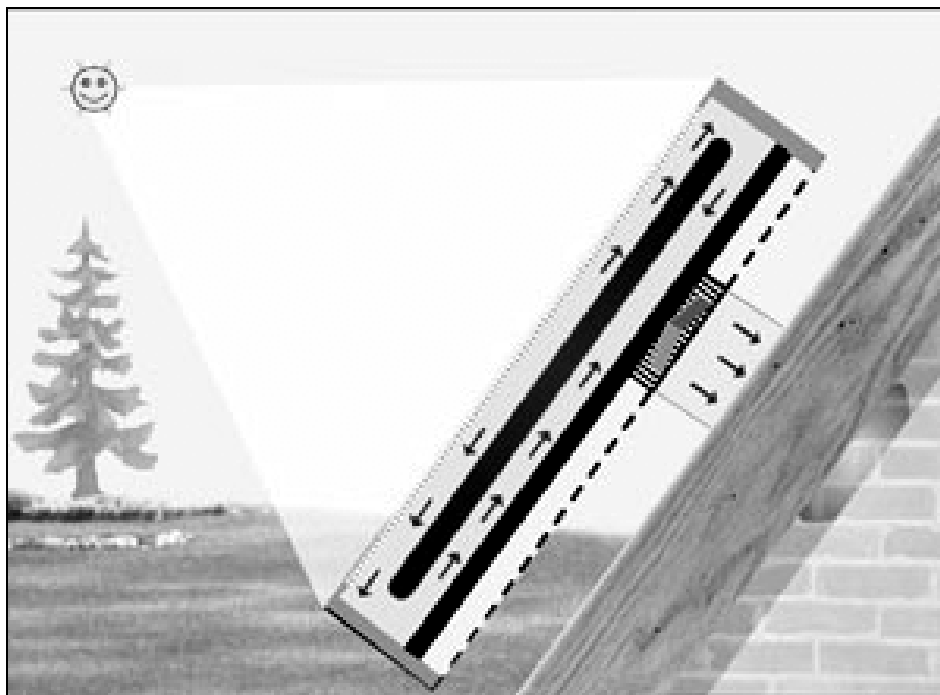
Rys. 2. Schemat działania kolektora powietrznego SolarVenti w cyklu ogrzewania [7]
