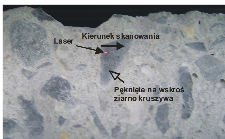
Rys. 6. Powierzchnia przełomu z widocznymi pęknięciami typu M i WK
