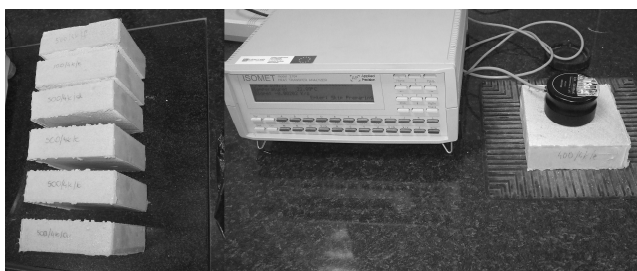
Rys. 1. Pomiar parametrów cieplnych próbek składowych
