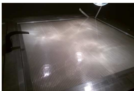
Fig. 5. Clear sheet of cellular polycarbonate, filled with PCM Rys. 5. Zdjęcie płyty poliwęglanu komorowego z PCM
