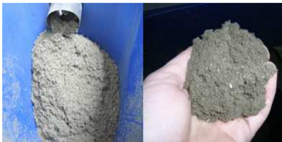
Rys. 3. Produkt termo - kompostowania w technologii Bionor Sludge
