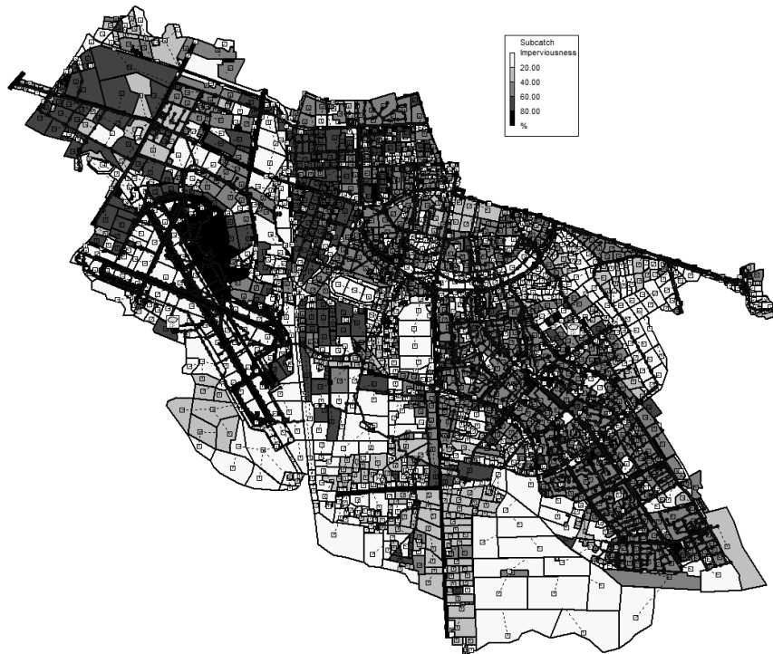
Rys. 3. Obszary cząstkowe i kanały na obszarze zlewni Potoku Służewieckiego w modelu SWMM Fig. 3. Sub-areas and channels in the Służewiecki Stream catchment in the SWMM model
