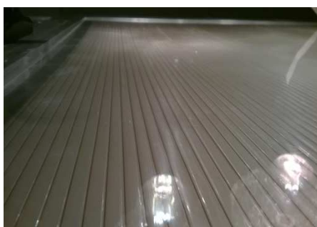
Fig. 4. Clear sheet of cellular polycarbonate Rys. 4. Zdjęcie płyty poliwęglanu komorowego z PCM
