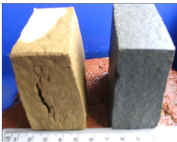
Rys. 5. Przykładowe próbki pyłu i mieszaniny poddane podsiąkaniu kapilarnemu – II etap badania
