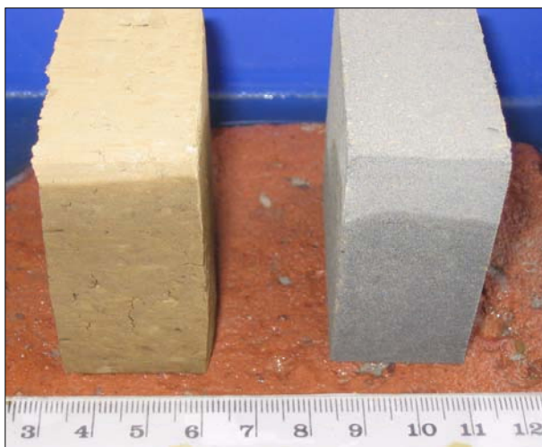
Rys. 4. Przykładowe próbki pyłu i mieszaniny poddane podsiąkaniu kapilarnemu – I etap badania
