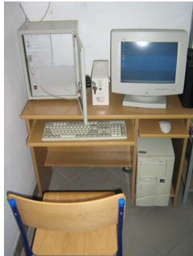
Rys. 1. Widok na stację ciągłego monitoringu hałasu
