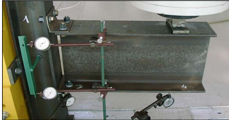
Rys. 4. Połączenie ryglu ze słupem z nakładkami z kątowników równoramiennych
