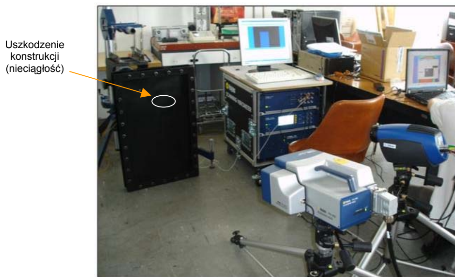
Rys. 4. Stanowisko badawcze do realizacji procedury termografii dynamicznej
