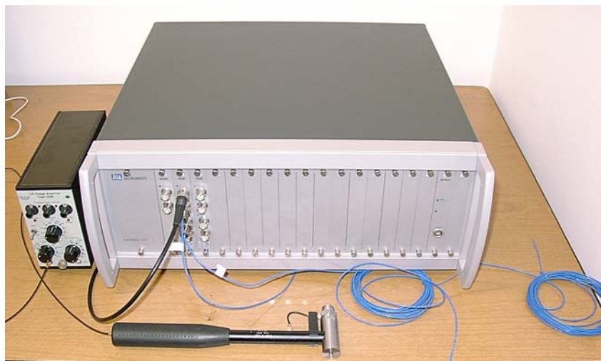
Rys. 4. Zestaw pomiarowy: wielokanałowy analizator Scadas III i młotek modalny
