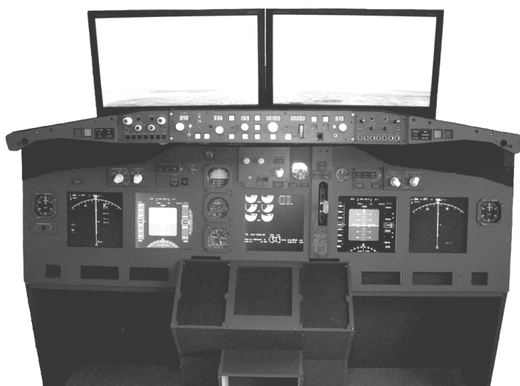
Rys. 4. Widok wykonanego w WAT symulatora kabiny samolotu pasażerskiego z interfejsami sprzętowymi i graficznymi
