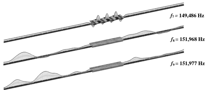
Rys. 6. Przykładowe formy własne drgań mostu z dominacją ruchu szyn
