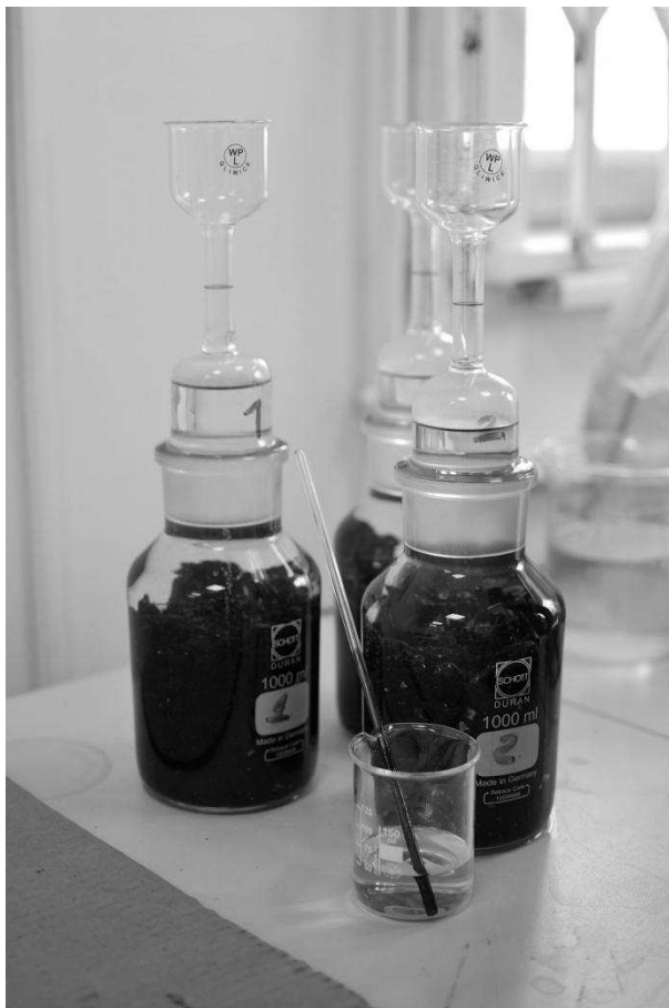
Rys. 9. Badanie wolnych przestrzeni nawierzchni do przygotowania której użyto nanorurek. Warszawa, rok 2012. Źródło: Mostostal Warszawa S.A.
