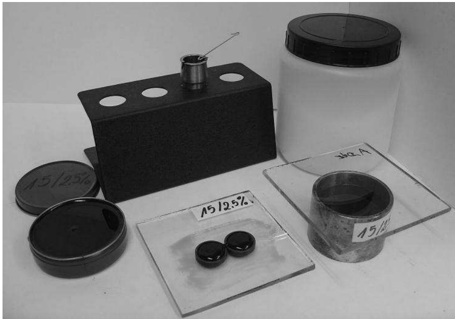
Rys. 7. Badania dodatków do mieszank na ciepło w laboratorium firmy. Warszawa, rok 2010. Źródło: Mostostal Warszawa S.A.
