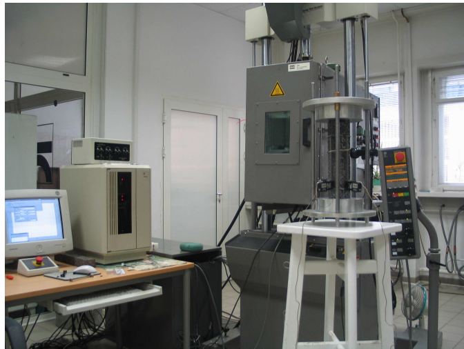
Fot. 7. Maszyna wytrzymałościowa MTS i próbka mma do badania TSRST
