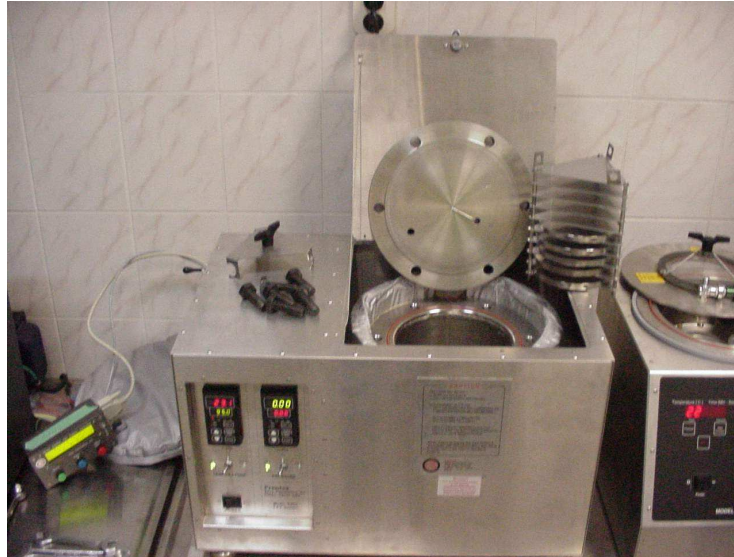
Fot. 5. Aparat PAV (Pressure Aging Vessel) – symulacja starzenia asfaltu w ok. 10 lat
