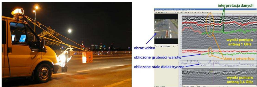
Fot. 9. Penetroradar oraz obraz wyników i interpretacji danych
