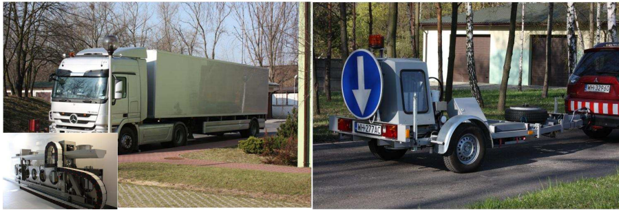
Fot. 8. Ugięciomierz laserowy TSD oraz ugięciomierz FWD
