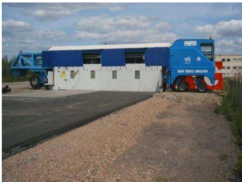
Fot. 11. Symulator obciążenia HVS na odcinkach testowych, Pruszków, 2008
