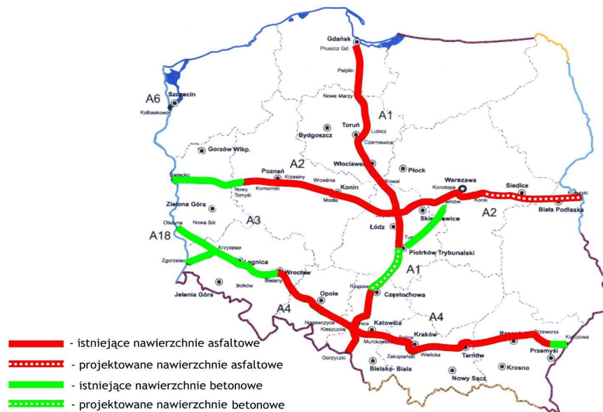
Rys. 2. Rodzaje nawierzchni na autostradach w Polsce
