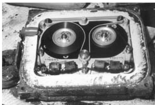
Rys. 1. Wnętrze magnetycznej czarnej skrzynki
