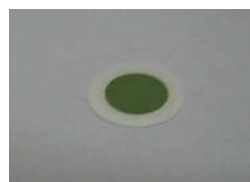
Rys. 4. Kompletnie stałotlenkowe ogniwo paliwowe na nośniku elektrolitowym Fig. 4. Complete solid oxide fuel cell with electrolyte support
