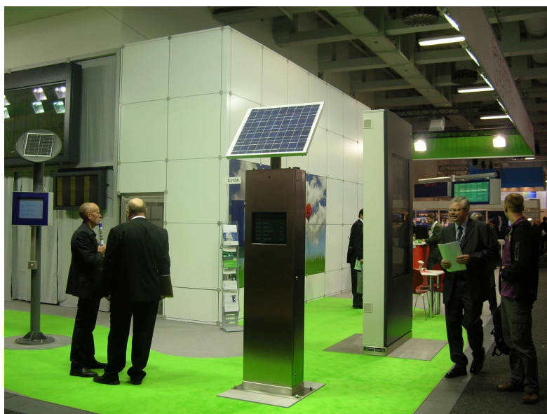
Fot. 2. Targi w Berlinie 2010 - wystawa urządzeń ulicznych działających dzięki pobieraniu energii słonecznej: informacja dla podróżujących na przystanku autobusowym. Zdjęcie: autorka
