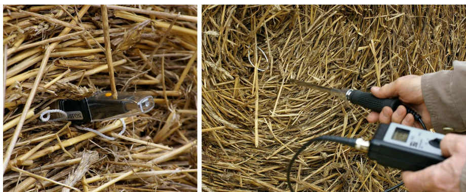
Rys. 5. Rejestrator wilgotności powietrza i temperatury (z lewej, przed umieszczeniem wewnątrz balotu); pomiar wilgotności słomy (z prawej) Fig. 5. Humidity and temperature recorder (left, before placing inside the bale); moisture contents measurement (right)
