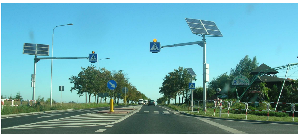
Fot. 3. Krajobraz współczesny: elementy fotowoltaiczne obok przejścia pieszego, oświetlające znaki uliczne. Zdjęcie wykonano na trasie Wrocław – Poznań. Zdjęcie: autorka Fig.3. The modern landscape: Photovoltaic elements next to the pedestrian crossing, giving light to the street signs. The photo made on the way Wrocław – Poznań. Photo: The author
