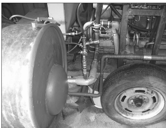
Rys. 2. Widok elementu grzejnego zabudowanego w wymienniku ciepła
