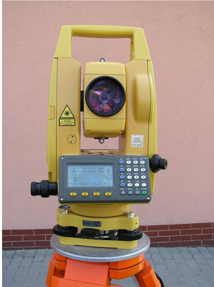
Rys. 1. Tachimetr SOUTH NTS-365R użyty w testach
