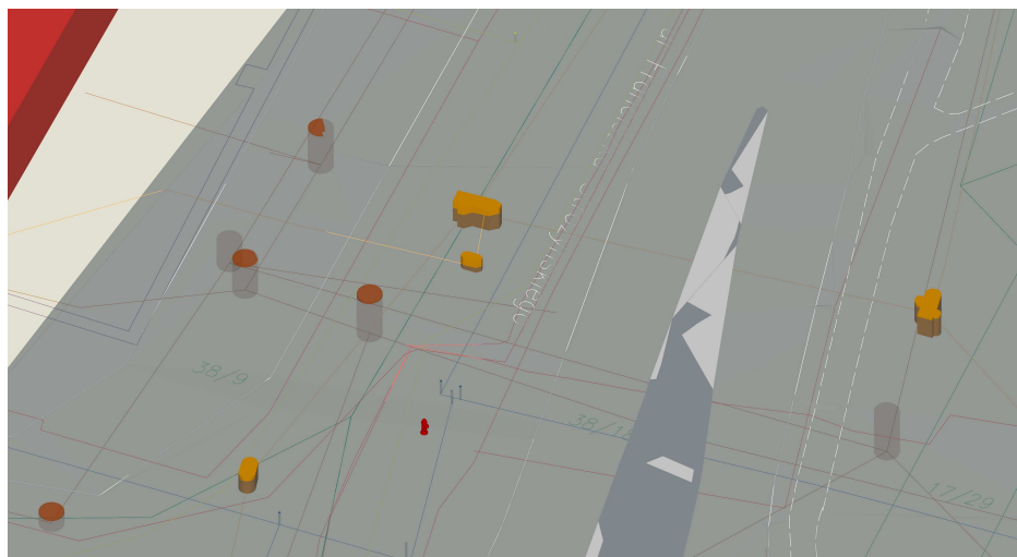
Rys. 6. Trójwymiarowy model skrzyżowania: a) widok z góry, b) symbolika przewodów podziemnych i urządzeń z nimi związanych
