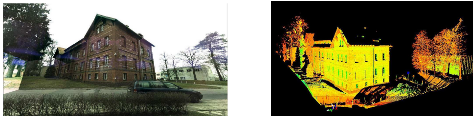
Rys. 5. Obiekt testowy i wynik pomiaru skanerem laserowym
