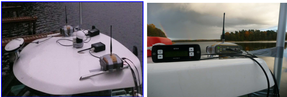
Rys. 3. Rozmieszczenie anten/odbiorników GNSS na kabinie łodzi oraz ruchomy moduł GSM/GPRS/EDGE (IGTS-R)
