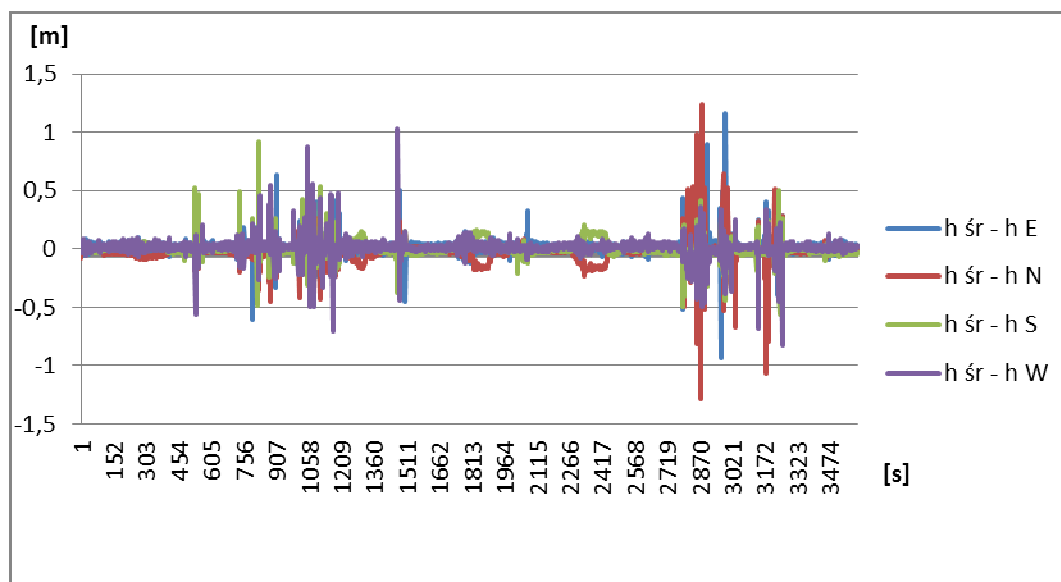
Rys. 6. Różnice wysokości poszczególnych odbiorników od środka łodzi
