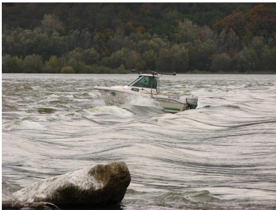
Rys. 9. Pomiar hydroakustyczny w pobliżu progu (wpłynięcie na próg z nurtem)
