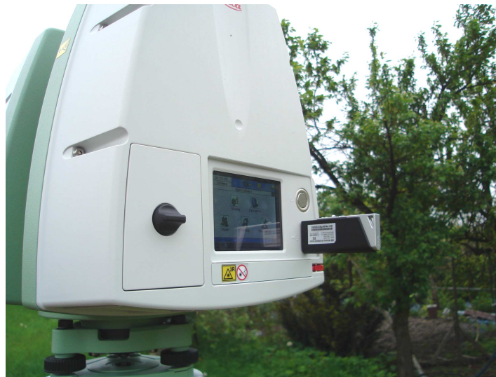
Rys. 4. Panel sterowania instrumentu wraz ze złączem Bluetooth
