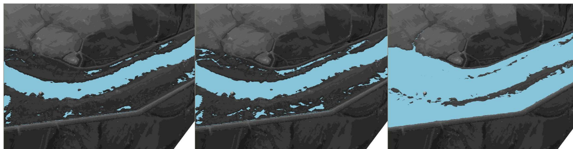
Rys. 7. Analiza zalania terenu przy podniesieniu poziomu rzeki (od lewej) o 1m, 3m, 9m z wykorzystaniem modelu wysokościowego ze skaningu laserowego
