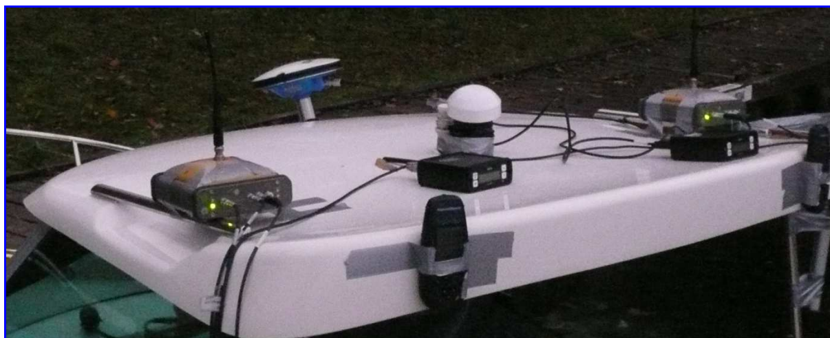
Rys. 1. Rozmieszczenie anten/odbiorników GPS na kabinie łodzi
