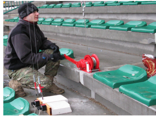
Rys. 11. Wciągarka i stanowisko pomiarowe
