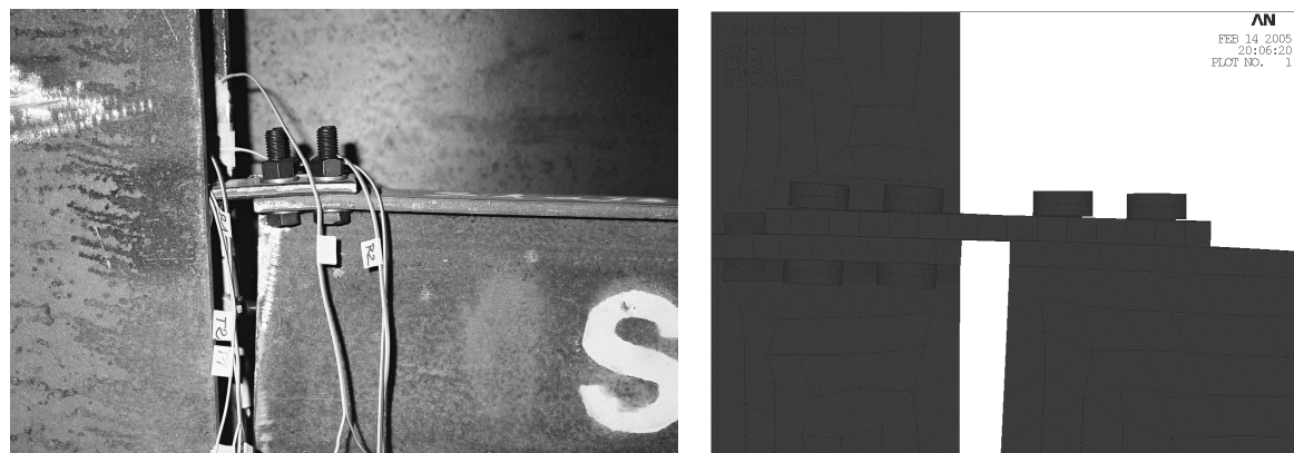
Rys.5. Efekt „przechylania się” śrub widoczny w: a) badanych węzłach, b) modelu numerycznym MES
