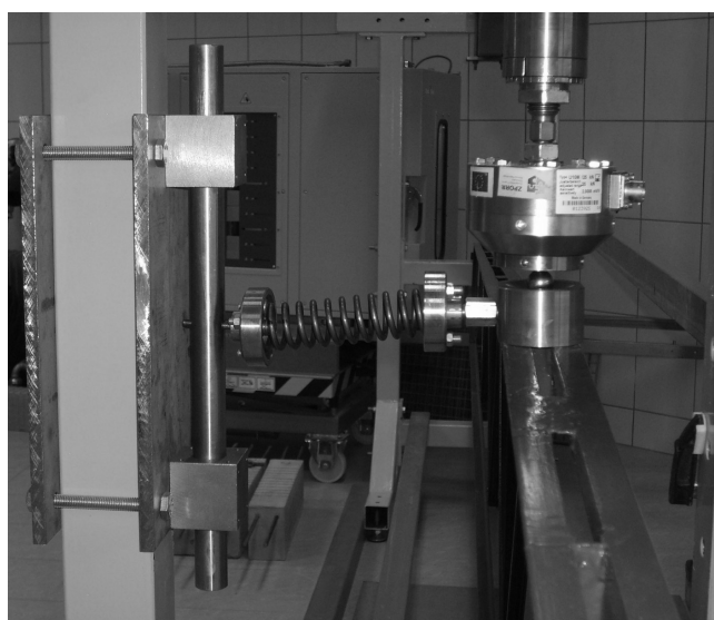
Rys. 3. Szczegół siłownika i podpory sprężystej
