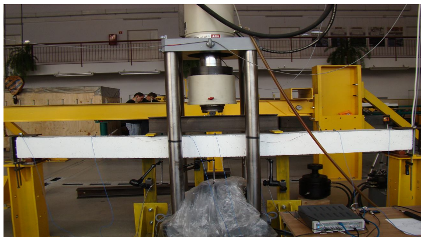
Rys. 2. Stanowisko do badań statycznych i sposób obciążania belek
