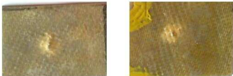
Rys. 2. Próbkę po działaniu obciążenia udarowego o energii 10J. Na dolnych zdjęciach widoczne miejsca przyłożenia obciążenia. Na górnych zdjęciach widok próbek od przeciwnej strony
