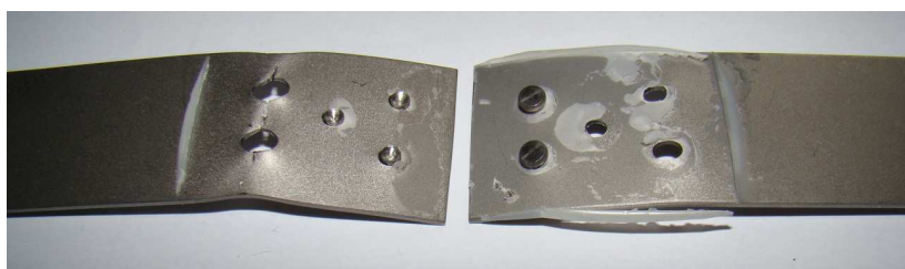
Rys. 9. Widok zniszczonej próbki klejowo-nitowej: szew nitów wielorzędowy
