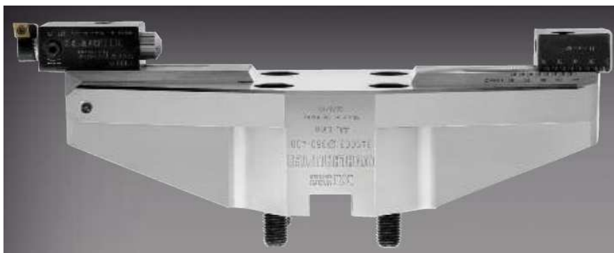
Rys. 2. Standardowe wytaczadło z aluminiowym korpusem o zakresie wytaczanych średnic: 100÷1025 mm; dokładność nastawy: 0,01 mm na średnicy, maksymalne dopuszczalne obroty : 2.500 min -1
