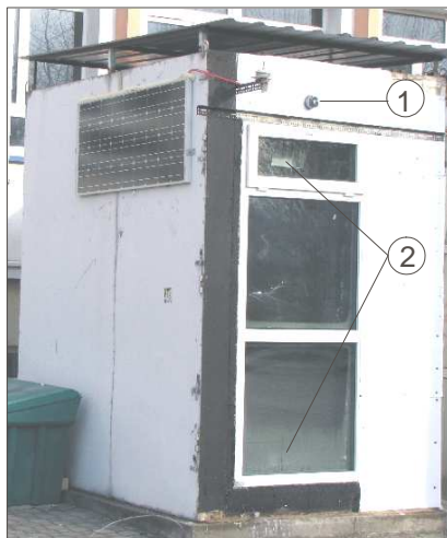
Fot.4. Polowa komora badawcza monitorująca stopień nagrzania absorbera w zależności od warunków klimatycznych; 1- pyranometr, 2- przepustnica.
