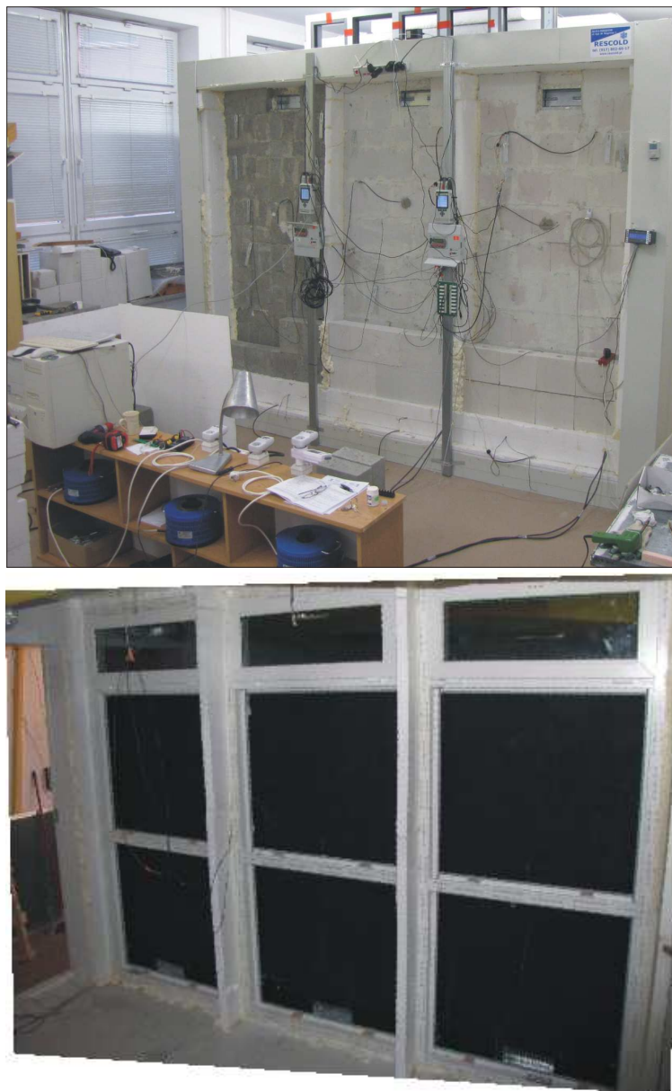
Fot.2. Widok symulatora od strony zewnętrznej oraz od strony komory mroźniczej. Fot.2. View of the simulator from the outside (above) and from the freezing chamber (below).
