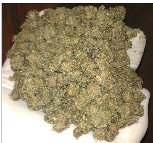
Rys. 2. Wstępnie nasycone wodą kruszywo otoczone piaskiem Fig. 2. Pre-saturated coarse aggregate surrounded by fine aggregate
