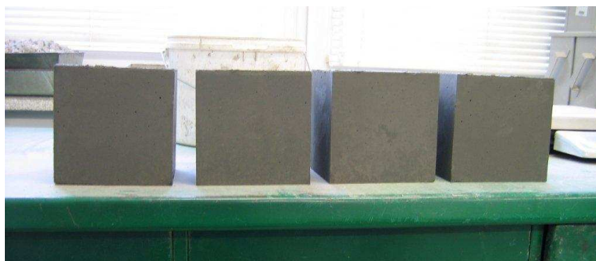
Fot. 4. Wygląd próbek wykonanych z ostatecznej receptury mieszanki betonowej Fot. 4. The appearance of samples taken from the final recipe of concrete
