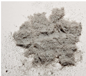
Rys. 3. Rdzeń VIP (pirogeniczna krzemionka) Fig 3. Core of VIP (fumed silica)
