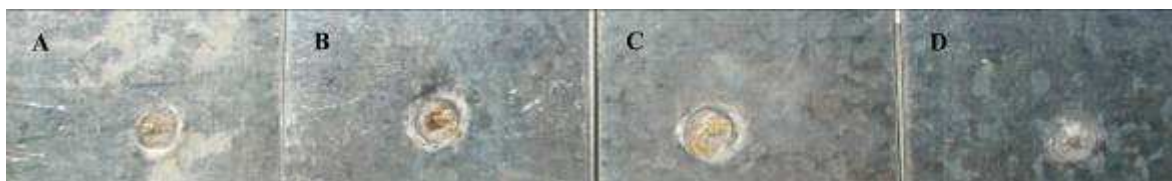
Fig. 4. Welding electrodes indentations on DX51D + Z (EN 10142/2000) steels
