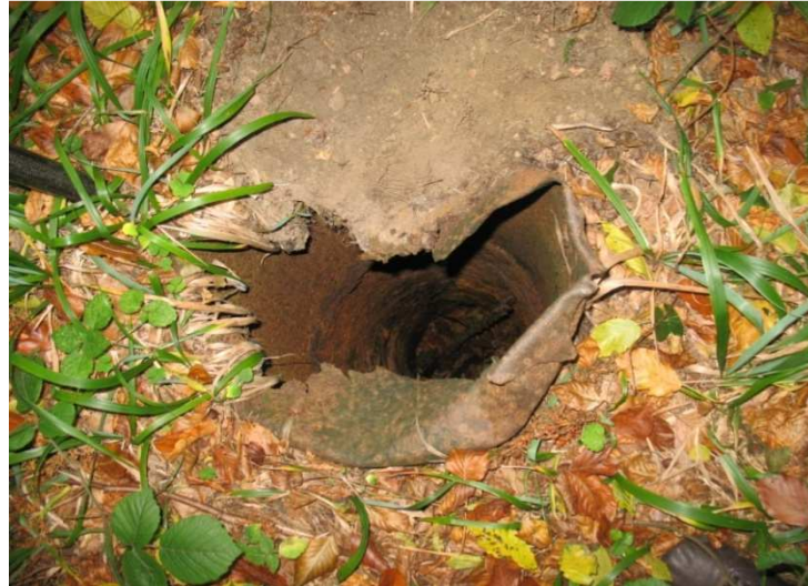
Rys. 2. Miejsce potencjalnego poważnego wypadku. Zlikwidowany otwór wiertniczy znajduje się około 10 m od Alei Wincentego Pola i 300 m od źródła „Bełkotki”; na powierzchni gleby widoczny fragment rury okładzinowej, pozostawionej prawdopodobnie z przyczyn technicznych i ze względów ekonomicznych. Gmina Iwonicz-Zdrój, woj. podkarpackie (Lipińska E.J. 2013)
