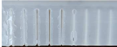
Rys. 4. Polipropylen (a-c) i polipropylen z talkiem (d-f) przecięty z prędkościami (od lewej): 1, 2, 3, 4, 6, 8, 10, 15 i 20 mm/s przy mocy lasera ok. 52W (75%)
