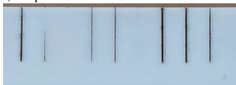
Rys. 3. Polipropylen (a-c) i polipropylen z talkiem (d-f) przecięty z prędkościami (od lewej): 20, 25, 30, 35, 40, 45, 50, 55, 60 mm/s przy mocy lasera 35W (50%)
