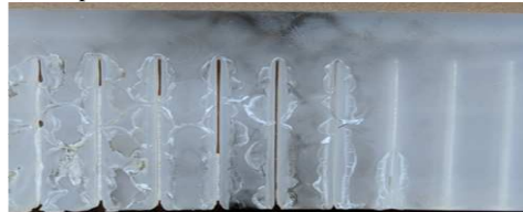
Rys. 5. Polipropylen (a-c) i polipropylen z talkiem (d-f) przecięty z prędkościami (od lewej): 1, 2, 3, 4, 6, 8, 10, 15 i 20 mm/s przy mocy lasera ok. 70W (99%)
