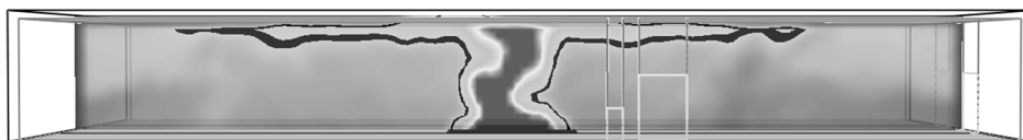
Rys. 4. Model MF1. Rozkład wartości temperatury po 11 minutach trwania pożaru. Pogrubioną linią oznaczono izotermę 100°C
