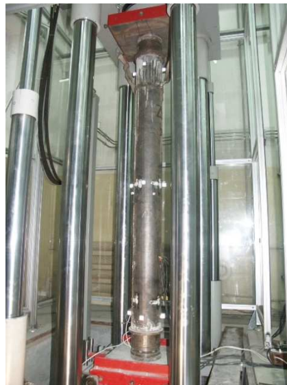
Rys. 2. Słup na stanowisku badawczym Fig. 2. A column on the test set-up
