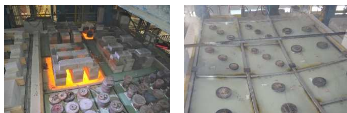
Rys. 6. Widok obciążonych grawitacyjnie poziomych elementów przeszklonych podczas badania odporności ogniowej. Autor: ITB
