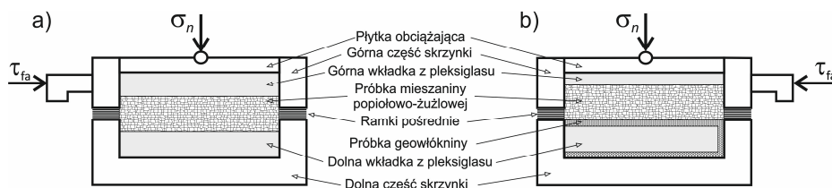
Rys. 1. Schemat skrzynki aparatu bezpośredniego ścinania do badań wytrzymałości na ścinanie (a) i oporu tarcia międzyfazowego (b)
