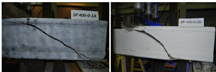
Rys. 6. Widok elementów opartych na podporze nieodkształcalnej po zniszczeniu a) niewypełnione kanały, b) wypełnione kanały
