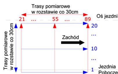
Rys. 3. Schemat tras pomiarowych
