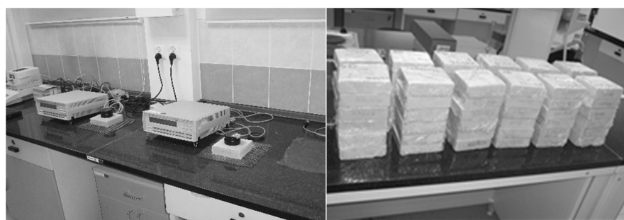
Rys. 2. Pomiary parametrów cieplnych próbek o różnym poziomie zawilgocenia
