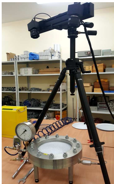
Rys. 6 .System pomiaru przemieszczeń ARAMIS
