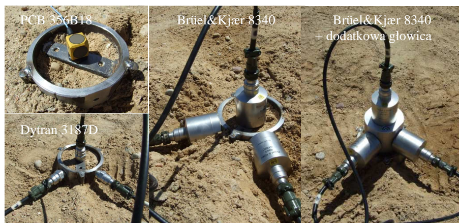
Rys. 1. Podstawy pomiarowe z zamontowanymi czujnikami przyspieszeń
