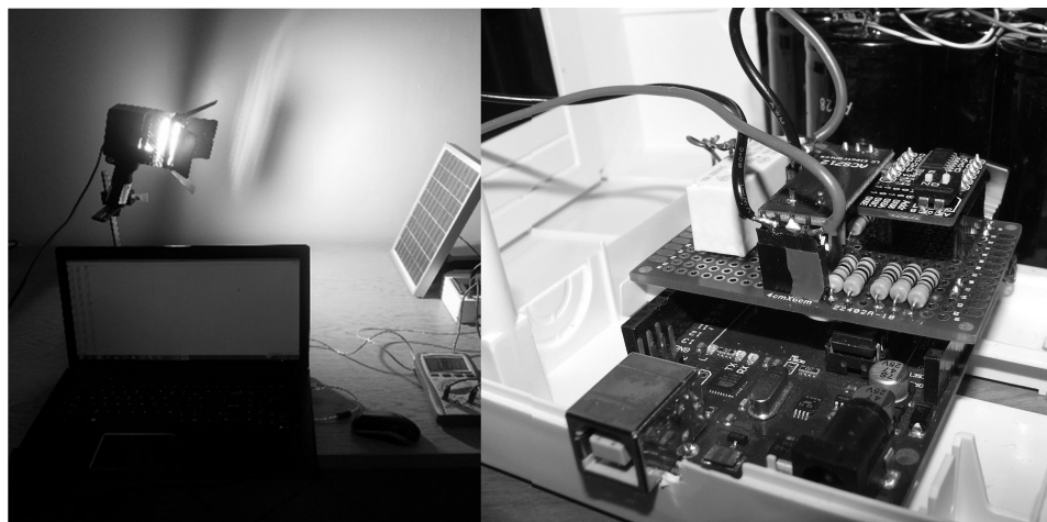
Rys. 1. Układ pomiarowy do badania charakterystyki I-V modułu polikrystalicznego o mocy 10W
