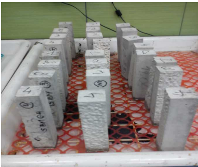
Rys. 1. Ustawienie próbek przy badaniu podciągania kapilarnego
