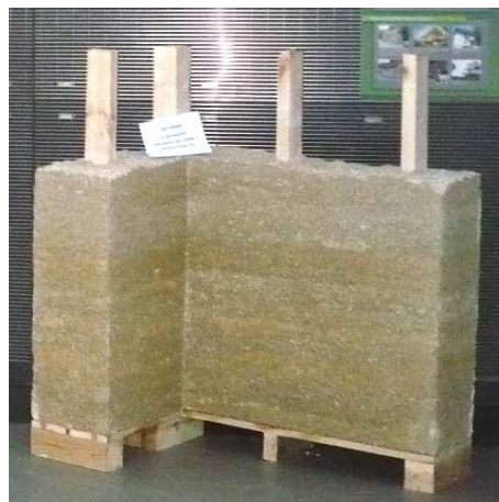
Rys. 2. Model ściany z kompozytu wapienno-konopnego (archiwum autorów)
