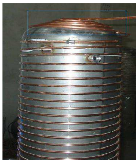
Rys. 3. Przykład skraplacza, na podstawie [3]
