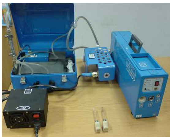
Rys. 2. Spektrometr RA-915+ z przystawką RP-91C
