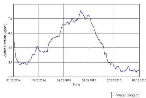
Rys. 9. Zawartość wilgoci w bloczku betonowym, ściana północna
