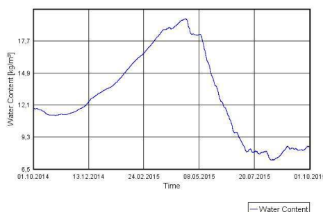
Rys. 4. Zawartość wilgoci w murze ceglanym, ściana zachodnia
