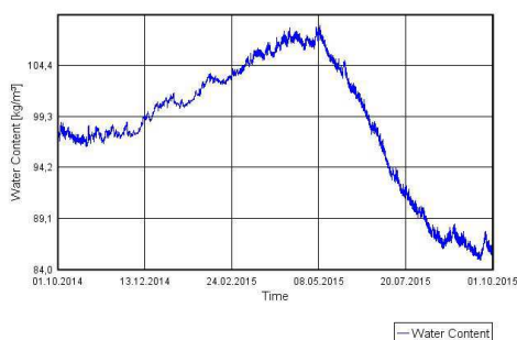
Rys. 11. Zawartość wilgoci w słupku drewnianym, ściana północna
