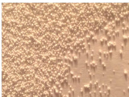
Rys.1. Powlekanie mikrokapsułki zawierające materiał zmiennofazowy, (nazwa handlowa Micronal®)
