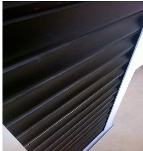
Rys.6. Zdjęcie prototypu mobilnej izolacji termicznej z PCMem od strony powłoki absorpcyjnej
