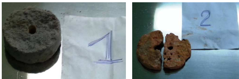
Rys. 3, 4. Próbkę nr 1 i 2 pobrana ze ściany zewnętrznej od wewnątrz w rejonie naroża
