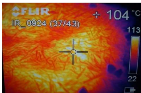
Rys. 4. Termogram mielników po wyjściu z komory roboczej
