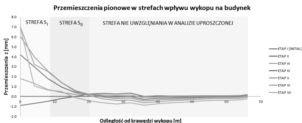
Rys. 8. Przemieszczenia pionowe podłoża gruntowego uzyskane z analizy numerycznej w strefie S_I i strefie S_{II} , opracowanie własne
