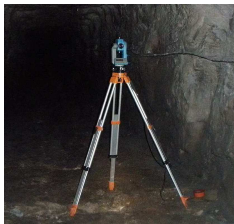
Rys. 13. Pomiar długości bazy tachimetrem
