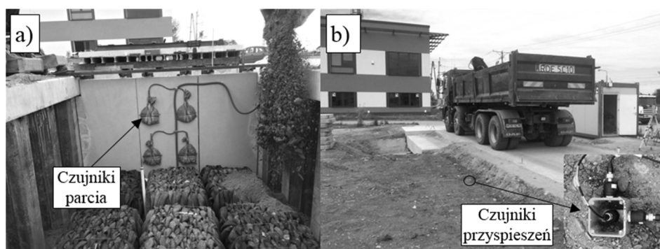
Rys. 5. Stanowisko do badań polowych: a) wypełnienie komory badawczej pakietami SZOS i materiałem zasypowym, b) próbne obciążenie dynamiczne
