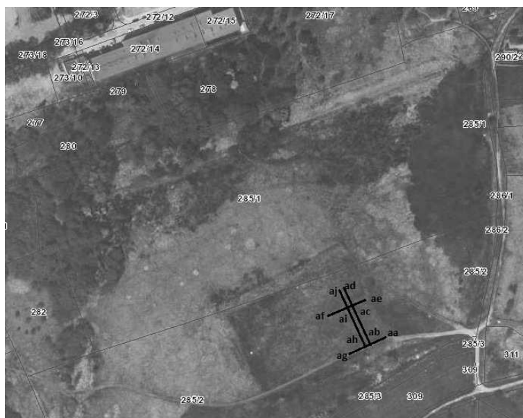
Rys. 3. Zdjęcie satelitarne terenu badań z numerami działek oraz zaznaczonymi profilami georadarowymi; opracowano na podstawie [9]
