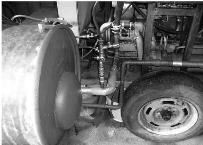
Rys. 2. Widok elementu grzejącego zabudowanego w wymienniku ciepła
