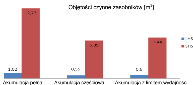
Rys. 8. Porównanie czynnych objętości zasobników chłodu w postaci jawnej (SHS) i utajonej (LHS)
