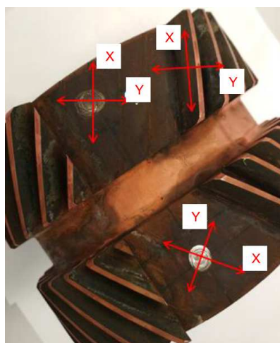
Rys. 6. Efekt końcowy cięcia elektroerozyjnego z oznaczonymi kierunkami badań
