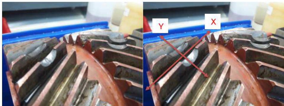
Rys. 5. Efekt końcowy polerowania elektrolitycznego uzębienia koła zębatego z zaznaczonymi kierunkami badań
