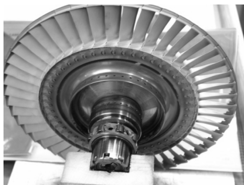
Rys. 8. Wirnik turbiny z elementami uszczelnienia labiryntowego
