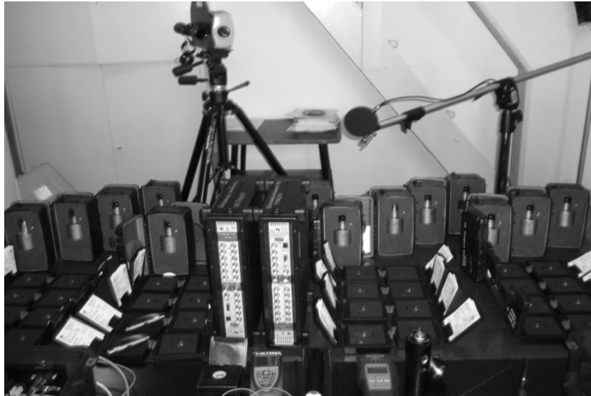
Rys. 2. System PULSE 3560 firmy Brüel & Kjær do pomiaru i analizy drgań
