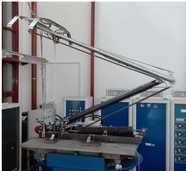
Rys. 2. Pantograf podczas badań dynamicznych
