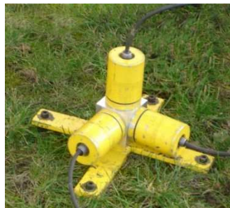
Rys. 4. Sposób mocowania czujników na gruncie
