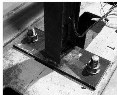
Rys. 4. Połączenie z fundamentem
