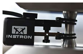
Rys. 5. Klepsydryczna mini-próbka rurkowa zamocowana wraz z ekstensometrem w maszynie wytrzymałościowej
