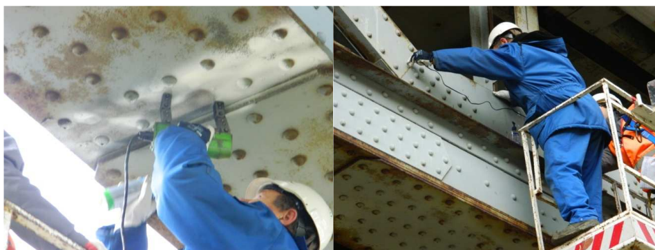
Rys. 5. Ilościowe badania NDT krytycznych elementów mostu
