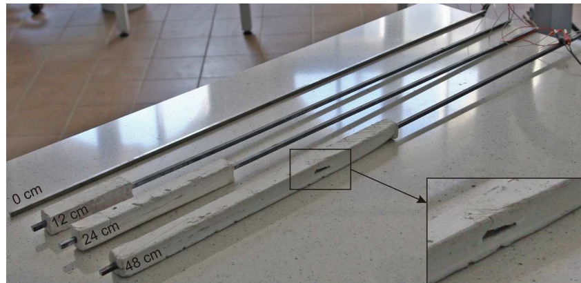
Rys. 2. Modele prętów osadzonych w zaprawie o różnej długości zakotwienia Fig. 2. Models of rods embedded in mortar of different anchorage lengths
