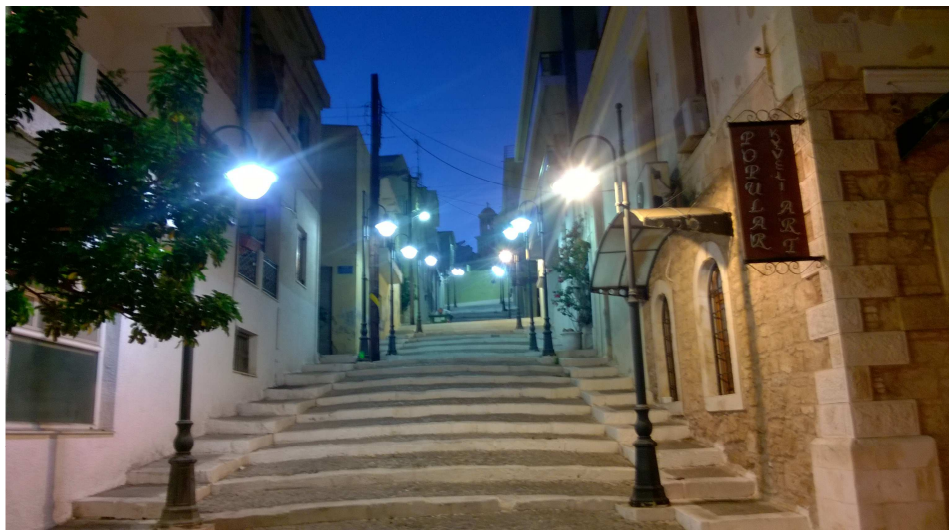
Rys. 8. Kreta, Grecja, oświetlenie uliczne „nowej generacji”, pomimo ograniczonego stożka światła oprawy powodują oślepienie kierowców i pieszych
