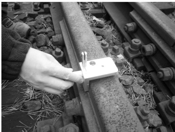
Rys. 4. Przykładnica magnetyczno-pomiarowa z linką pomiarową (fotografia własna)
