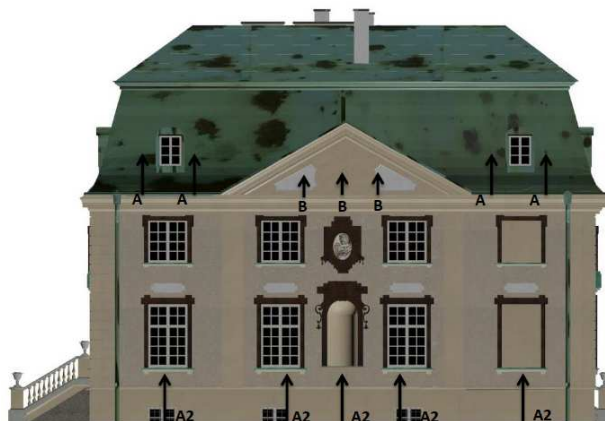
Rys. 5. Rozmieszczenie opraw, fasada południowa [3]
