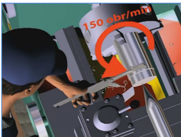
Rys. 5. Wektor ruchu obrotowego wrzeciona tokarki wraz z podaną wartością prędkości obrotowej podczas toczenia metalowej części
