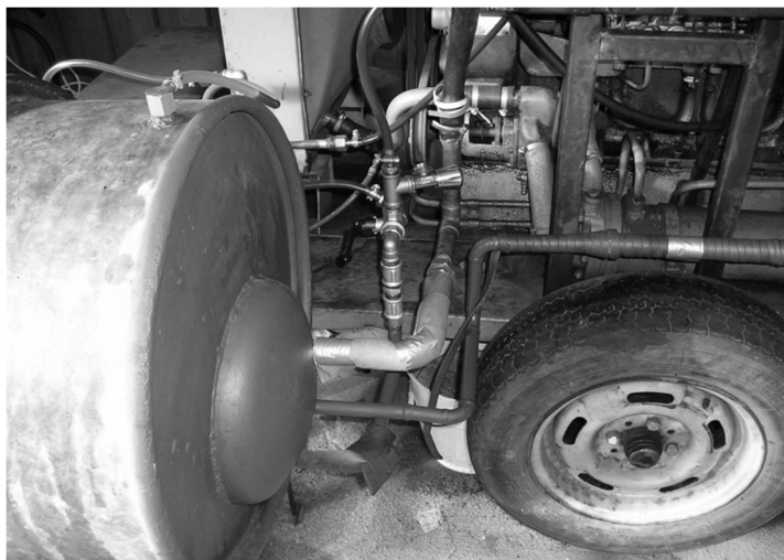
Rys. 2. Widok elementu grzejącego zabudowanego w wymienniku ciepła
