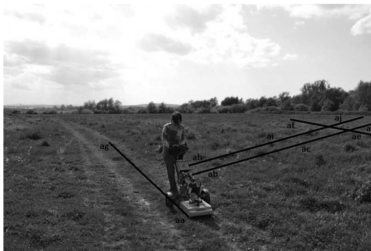
Rys. 4. Teren badań z poglądowo naniesionymi profilami georadarowymi
