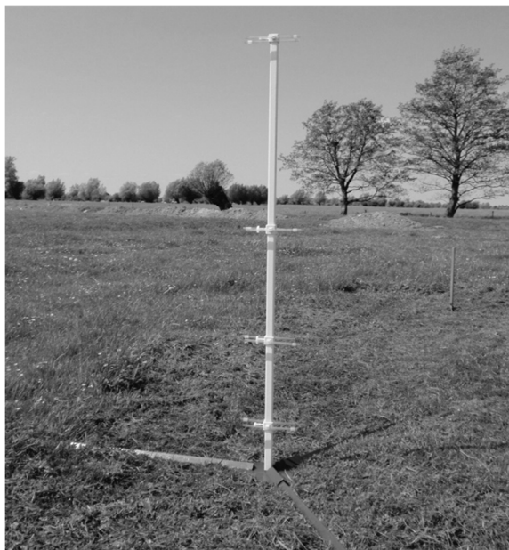
Rys.2. Maszt przygotowany do pomiarów emisji amoniaku
