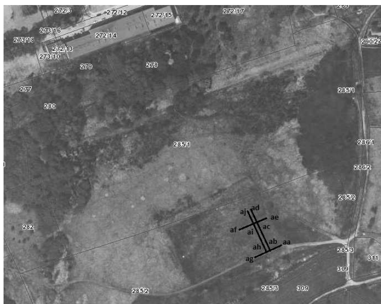
Rys. 3. Zdjęcie satelitarne terenu badań z numerami działek oraz zaznaczonymi profilami georadarowymi; opracowano na podstawie [9]
