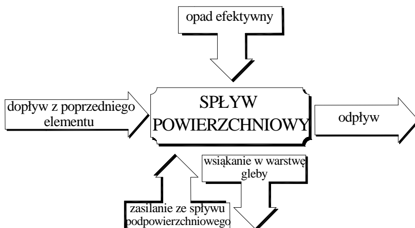
Rys. 4. Schemat obliczeniowy spływu powierzchniowego
