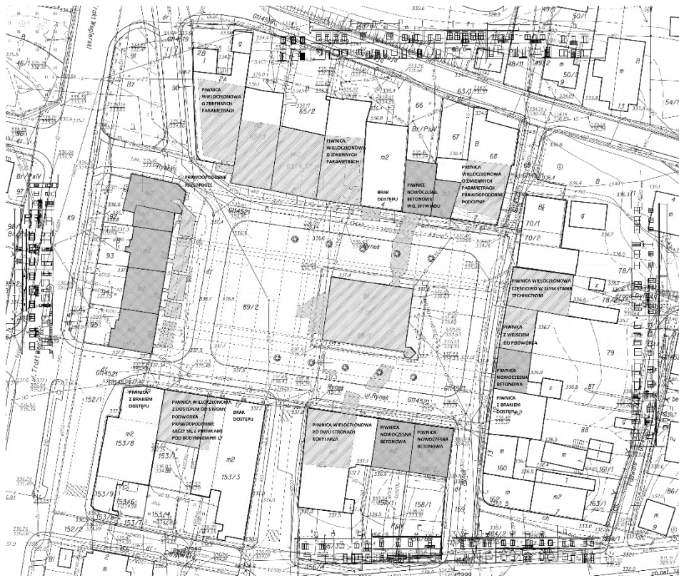
Rys. 2. Plan sytuacyjny z zaznaczonymi trasami pomiarów georadaru, zakreśkowanymi nieregularnymi obszarami anomalii geologicznych w obrębie płyty rynku, oraz spenetrowanymi i niedostępnymi piwnicami. Rys. arch. M. Gransicki 2014
