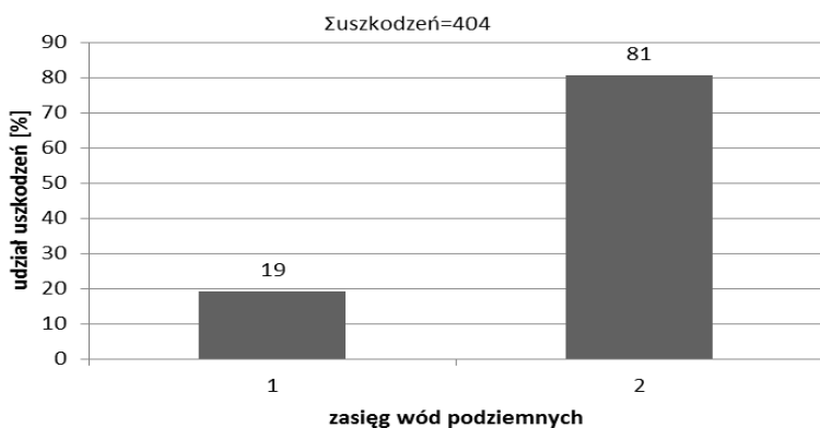
Rys. 9. Rozkład uszkodzeń przewodów wodociągowych w 2012 r. w zależności od zasięgu występowania wód gruntowych; 1 – wody gruntowe powyżej 2 m p.p.t, 2 – wody gruntowe poniżej 2 m p.p.t.
