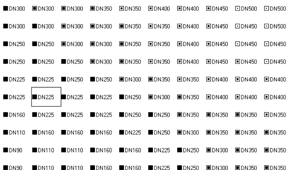
Rys. 7. Przykładowa mapa topologiczna do oceny średnic rurociągów
