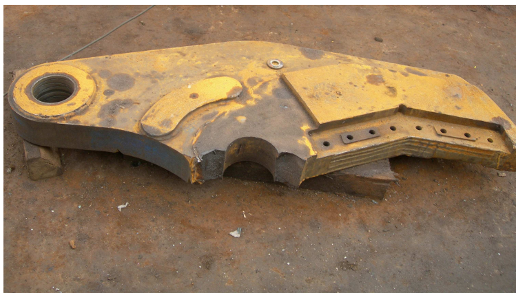
Рис. 1. Характерное разрушение детали шарнирного узла
