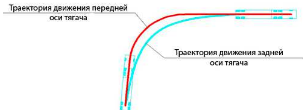
Рис. 3. Траектория движения автопоезда при осуществлении маневра на кривой радиусом 15 м.
