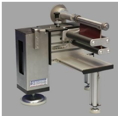
Rys. 8. Wyznaczenie wartości strzałki ugięcia badanej próbki
