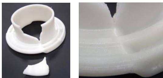
Rys. 7. Pęknięcie tulei z kołnierzem pogrubionym
