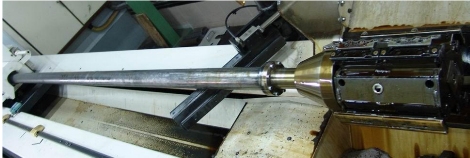
Rys. 15. Żerdź z przegubami do mocowania głowicy honowniczej na wrzecionie obrabiarki
