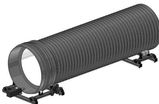
Rys. 10. Model stanowiska do obrotu rury o dowolnej długości z połączeniem kielichowym
