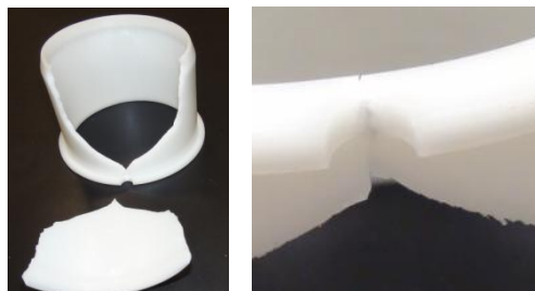
Rys. 9. Pęknięcie tulei z kołnierzem osłabionym
