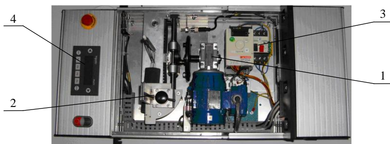
Rys. 11. Widok urządzenia (bez osłon): 1 – zespół napędowy, 2 – głowica wielofunkcyjna, 3 – elementy systemu sterowania, 4 – panel operatorski
