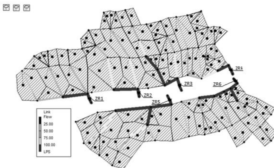
Rys. 3. Schemat modelu hydrodynamicznego sieci podczas symulacji przepływu ścieków w kanałach
