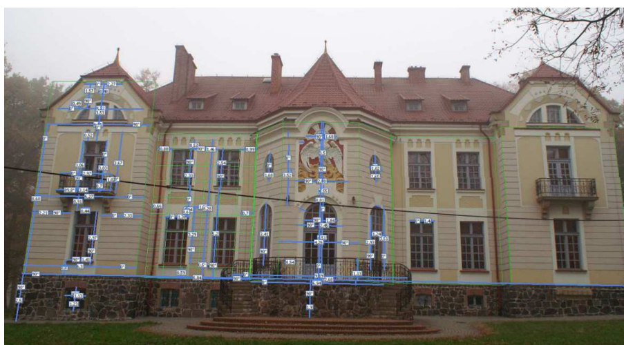
Rys. 2. Przykład naniesienia siatki orientacji perspektywy na fotografię obiektu [11]
