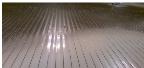
Rys. 5. Częściowo roztopiony PCM wewnątrz poliwęglanu komorowego
