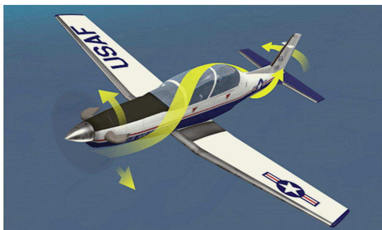
Rys. 2. Asymetryczne oddziaływanie strumienia zaśmigłowego w samolocie Beechcraft T-6 Texan II, na podstawie [2]
