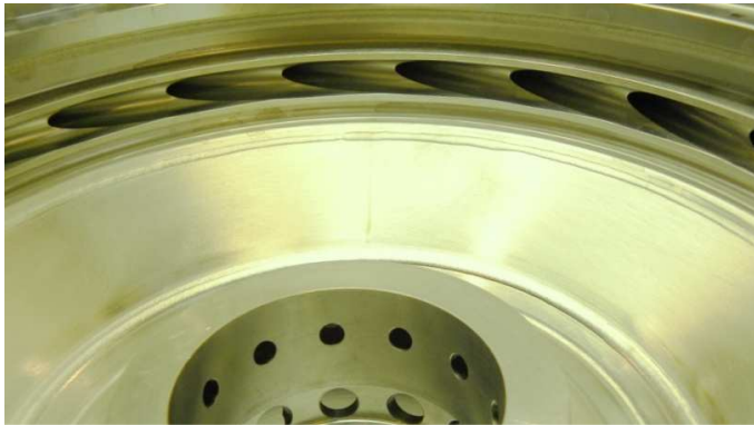
Rys. 3. Widok od strony wirnika elipsoidalnych krawędzi natarcia dyfuzora rurkowego (dzięki uprzejmości firmy Pratt & Whitney – dar dla Politechniki Rzeszowskiej)
