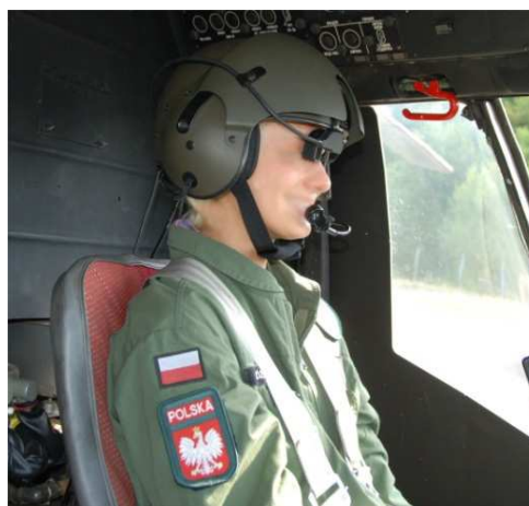
Rys. 4. Obsługa przedlotowa z dziennym wyświetlaczem nałęczmowym DWN-1
