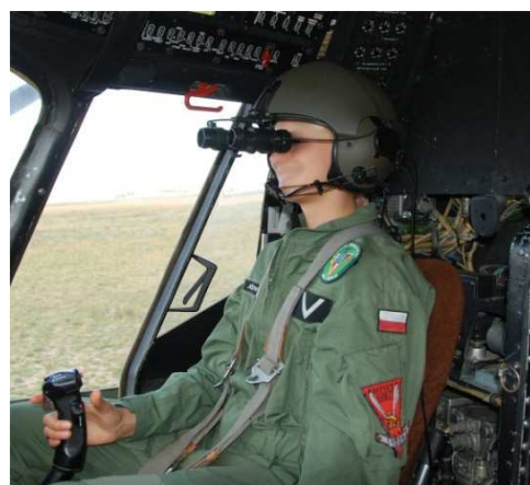
Rys. 5. Obsługa przedlotowa z nocnym wyświetlaczem nałęczmowym DWN-1
