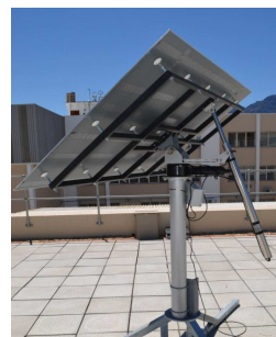
Rys. 5. Heliostat Helio 40, na podstawie [5]
