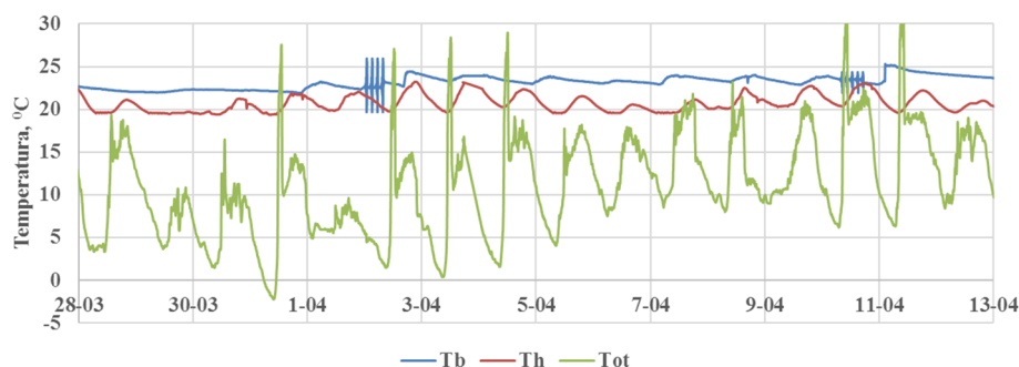
Rys. 5. Przykładowe zarejestrowane zmiany temperatury w ogrzewanych pomieszczeniach oraz temperatura otoczenia: Tb – temperatura w pomieszczeniach biurowych, Th – temperatura w hali drukarni, Tot – temperatura otoczenia.
