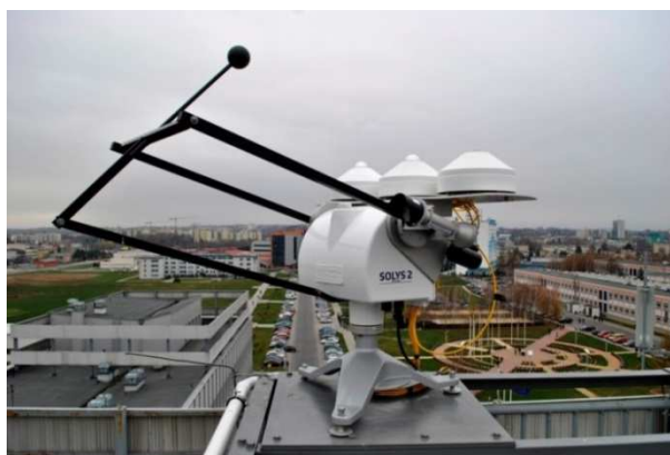
Rys. 1. Układ śledzenia Słońca z zamontowanymi czujnikami promieniowania całkowitego, bezpośredniego, rozproszonego oraz promieniowania cieplnego atmosfery
