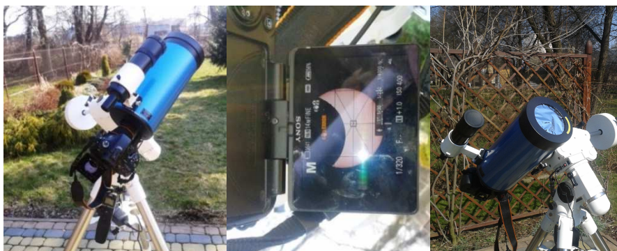
Rys. 2. Obserwacja wizualna zaćmienia Słońca: teleskop typu Maksutow-Cassegrain z aparatem fotograficznym DSLR SONY A-57 na montażu paralaktycznym
