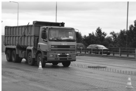
Rys. 2. Samochód ciężarowy wykorzystywany do wzbudzenia drgań mostu
