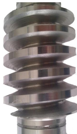
Rys. 5. Fragment kodu oraz fotografia ślimaka wykonanego przy użyciu oprogramowania
