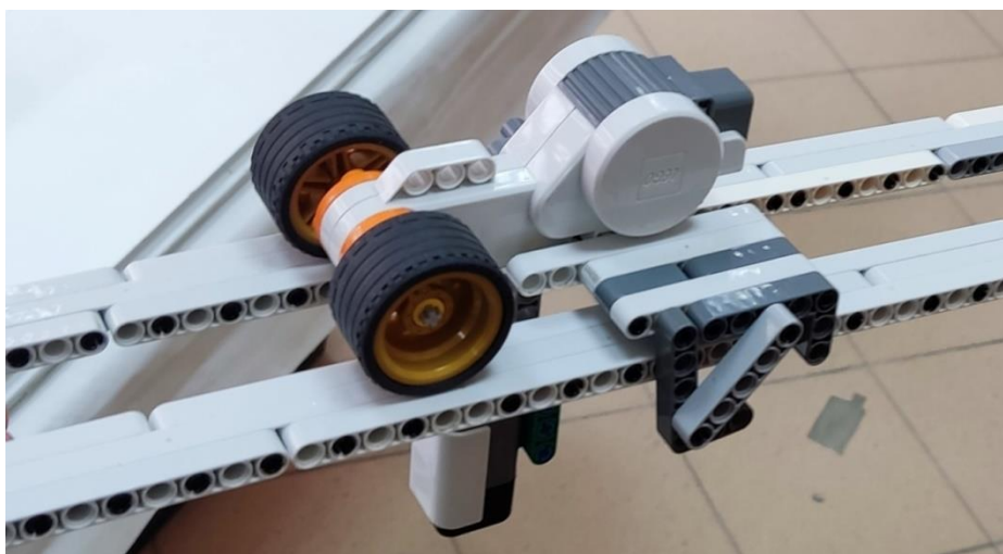
Rys. 1. Prototyp układu skanującego (szyny, po której porusza się silnik)
