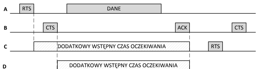
Rys. 3.13. Transfer danych z zastosowaniem CSMA/CA wraz z rozszerzeniami
