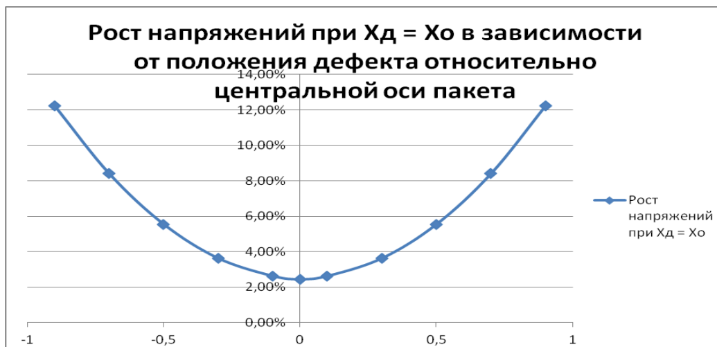
Рис. 1. Рост напряжений (%) при расположении центра дефекта на центральной оси пакета X_d в зависимости от положения дефектного слоя в пакете
