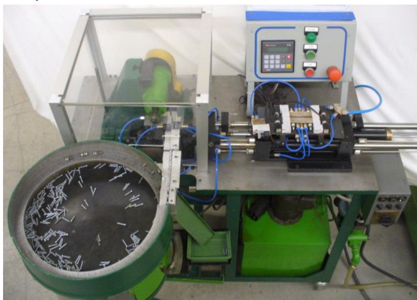
Rys. 1. Widok zrobotyzowanego stanowiska do nacinania rowków we wkrętach walcowych
