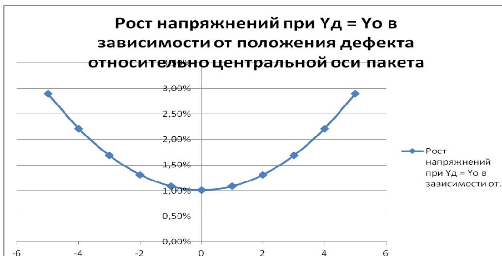
Рис. 2. Рост напряжений (%) при расположении центра дефекта на центральной оси пакета Y_d в зависимости от положения дефектного слоя в пакете
