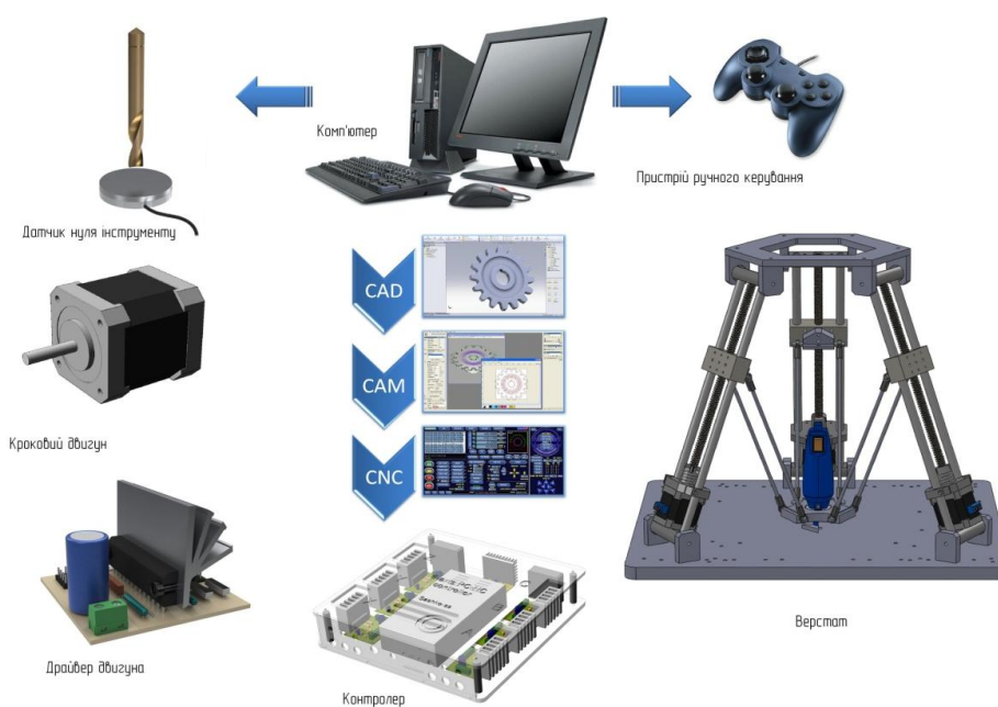
Рис. 9. Структура системы управления станком
