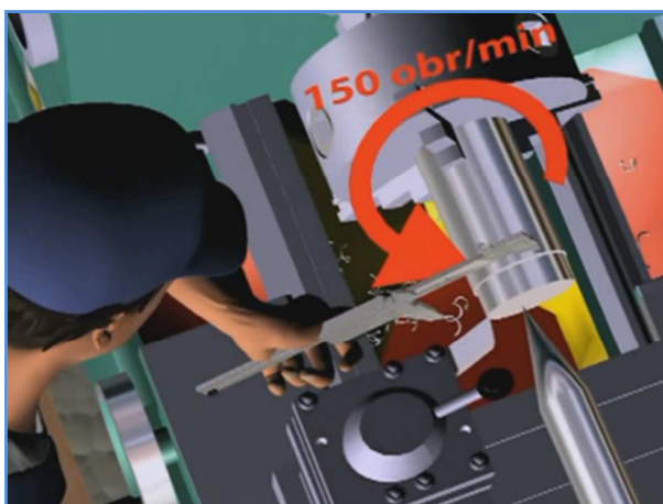
Rys. 5. Wektor ruchu obrotowego wrzeciona tokarki wraz z podaną wartością prędkości obrotowej podczas toczenia metalowej części
