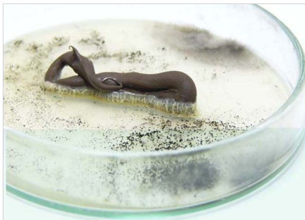
Fot. 4. Silikon uniwersalny Tytan pod działaniem pleśni Alternaria alternata
